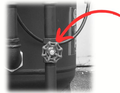
Lors du démarrage de la machine, il est recommandé de garder la vanne à volant ouverte (**en butée dans le sens antihoraire**).
